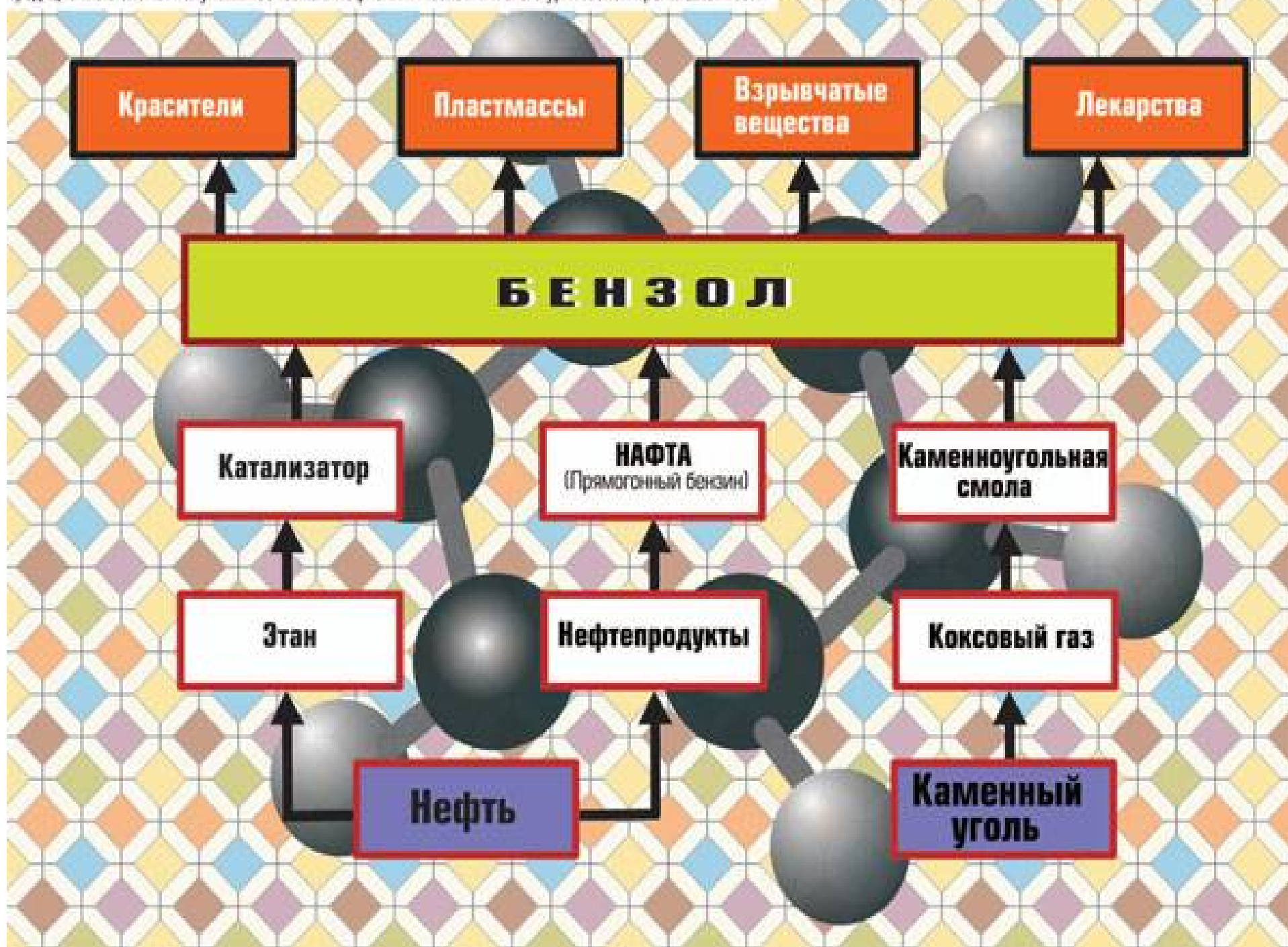
Традиционные схемы получения бензола в нефтехимической и металлургической промышленности
